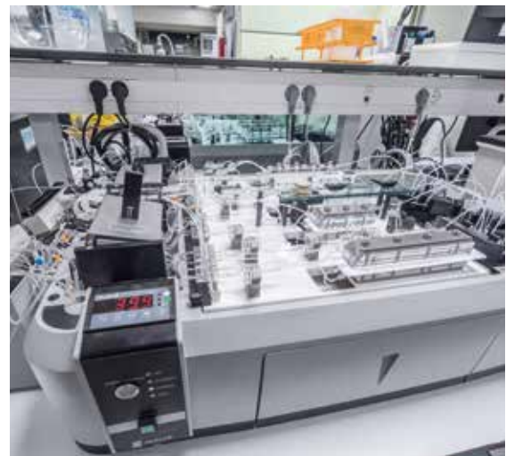
Eén van de twee modulaire continuous flow analyzers (CFA's).
